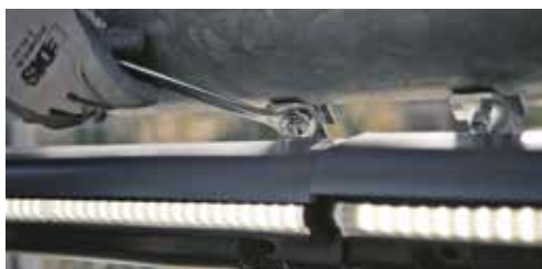
5. Un particolare del fissaggio del G-light-barriera
